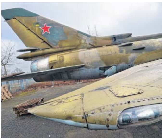
„Schwenkflügel“: Die Außenflügel der Suchoi sind schwenkbar, in einem Bereich von 28 bis 62 Grad manuell steuerbar.
